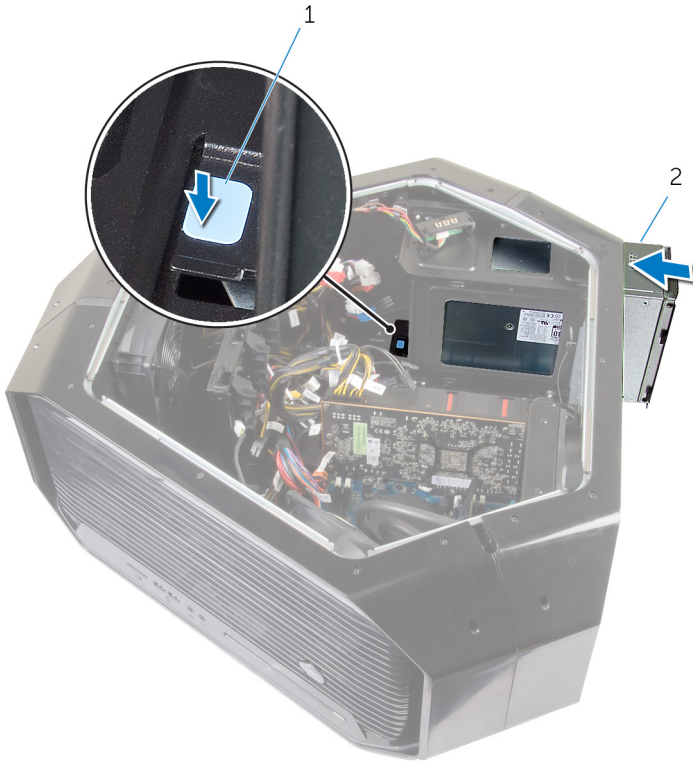
圖 52. 裝回電源供應器
